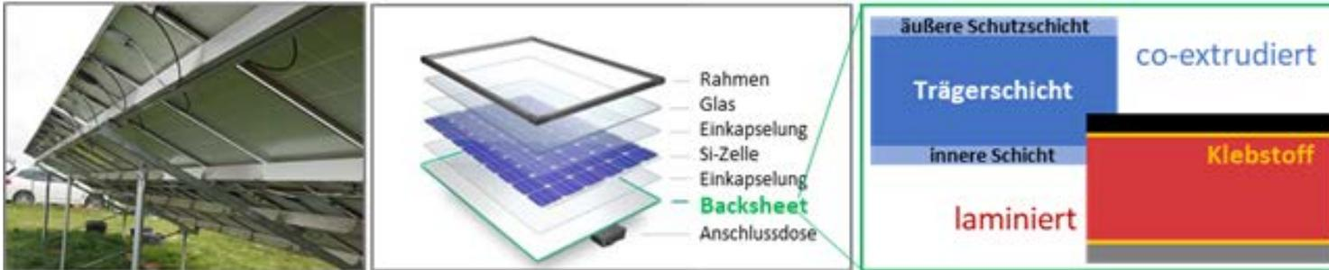
*Aufbau von PV-Modulen und mehrschichtigen, polymeren Backsheets*
